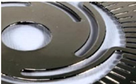
Die Photolithographie ist ein lithographisches Reproduktionsverfahren, bei dem mittels Belichtung Muster auf einer mit Photoemulsion beschichteten Grundplatte aufgebracht werden. Diese Verfahren ermöglicht die Herstellung von sehr feinen 2D-Teilen.
